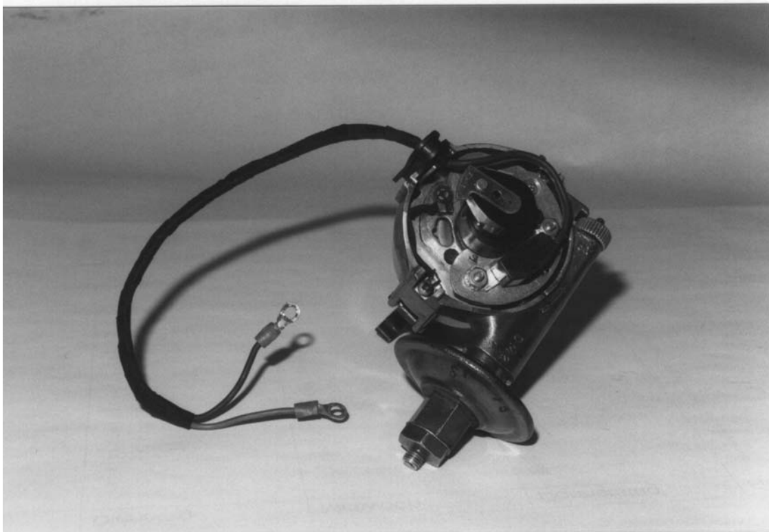
Fertig umgebauter Verteiler mit elektronischer Zündung für MAG/MGB
