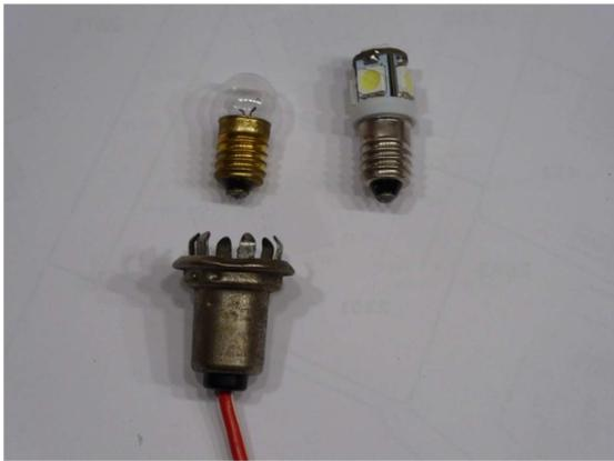
Für den Tachometer und den Drehzahlmesser können die Lampen durch entsprechende LED Lampen ganz einfach ersetzt werden.
